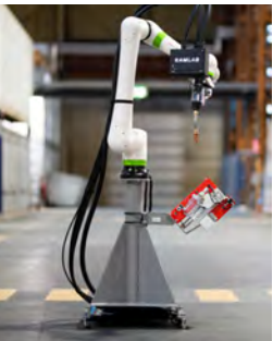
3次元形状スキャンと溶接パス自動生成を組み合わせた「RAMLAB」協働ロボットシステム
