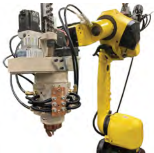
当社独自技術の世界初センタワイヤ供給式TIG造形トーチ「RotoTIG」により無欠陥造形を実現
